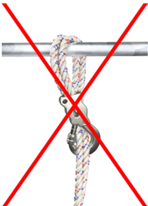
Abb. 79 Unsachgemäßes Anschlagen eines Reibungsfalldämpfers
