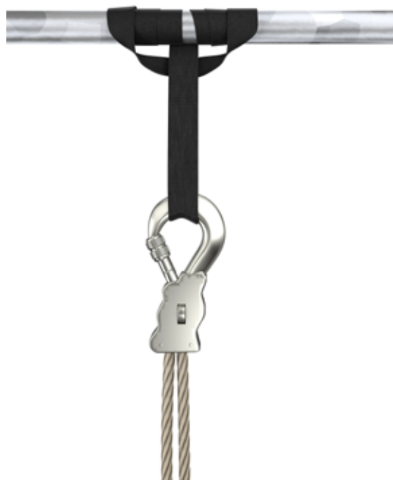
Abb. 80 Richtiges Anschlagen: Zur Erhaltung der Funktionsfähigkeit des Reibungsfalldämpfers wird eine Bandschlinge als Anschlaghilfe verwendet
